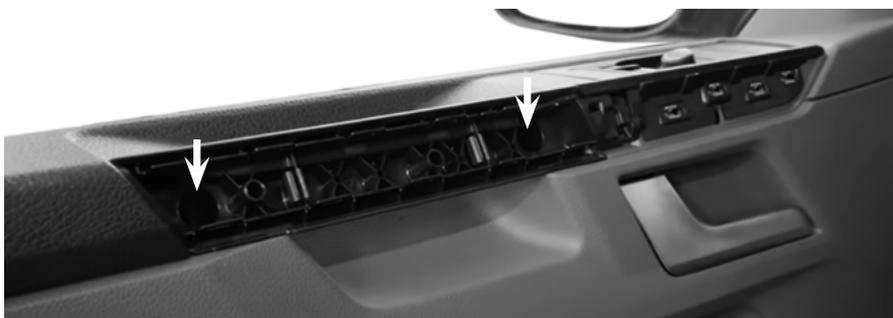
Öffnen Sie danach die beiden Bayonet Verschlüsse auf der Unterseite der Türverkleidung mit Hilfe eines 10 mm Gabelschlüssels. Drehen Sie den Verschluss um 90°. Danach können Sie vorsichtig mit Hilfe eines Hebelwerkzeuges / flachen Schraubenzieher die Türpappe lösen.
